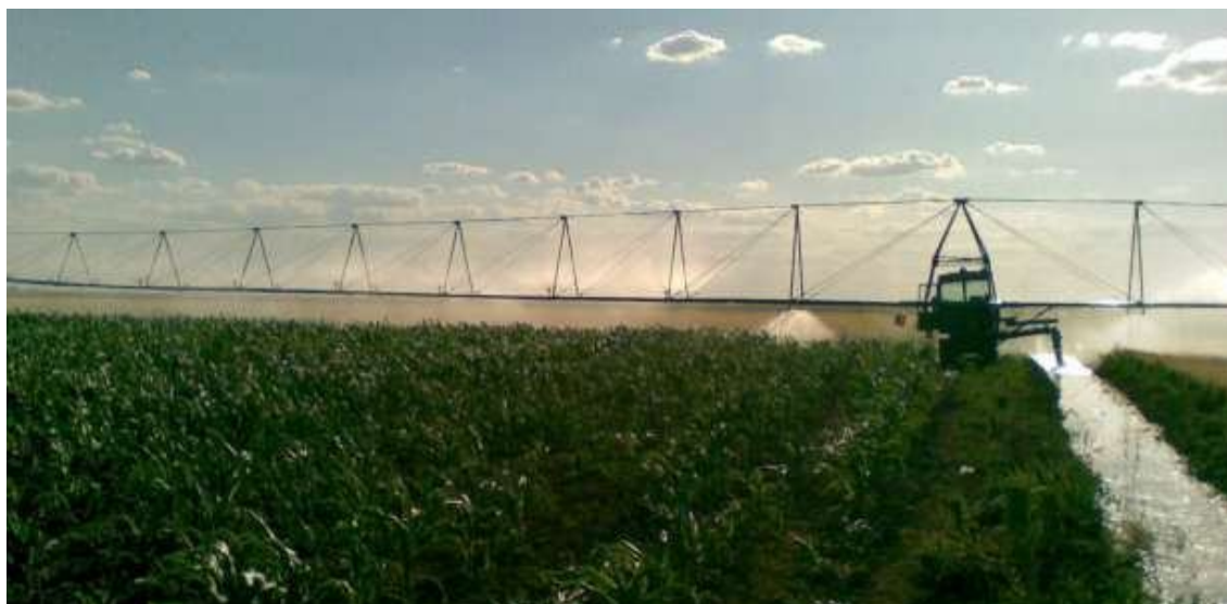
Рисунок 2 – Дождевальный агрегат ДДА-100МА
