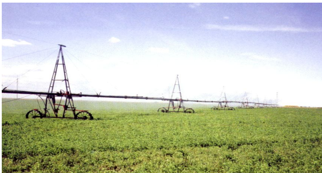
Рисунок 5 - Дождевальная машина «Фрегат»
